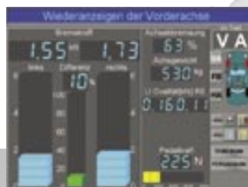
Bremstest 3-dimensionale Balkengrafik und numerische Darstellung verschiedener Bremsenkenngößen.
